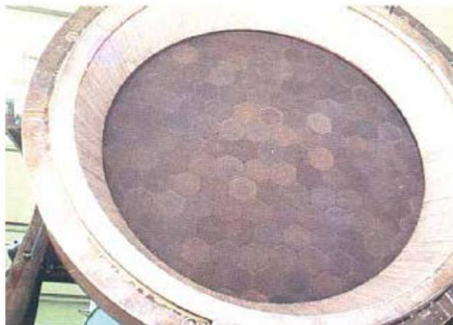
**Fig 2.9** schéma d'un récepteur volumétrique [25]
