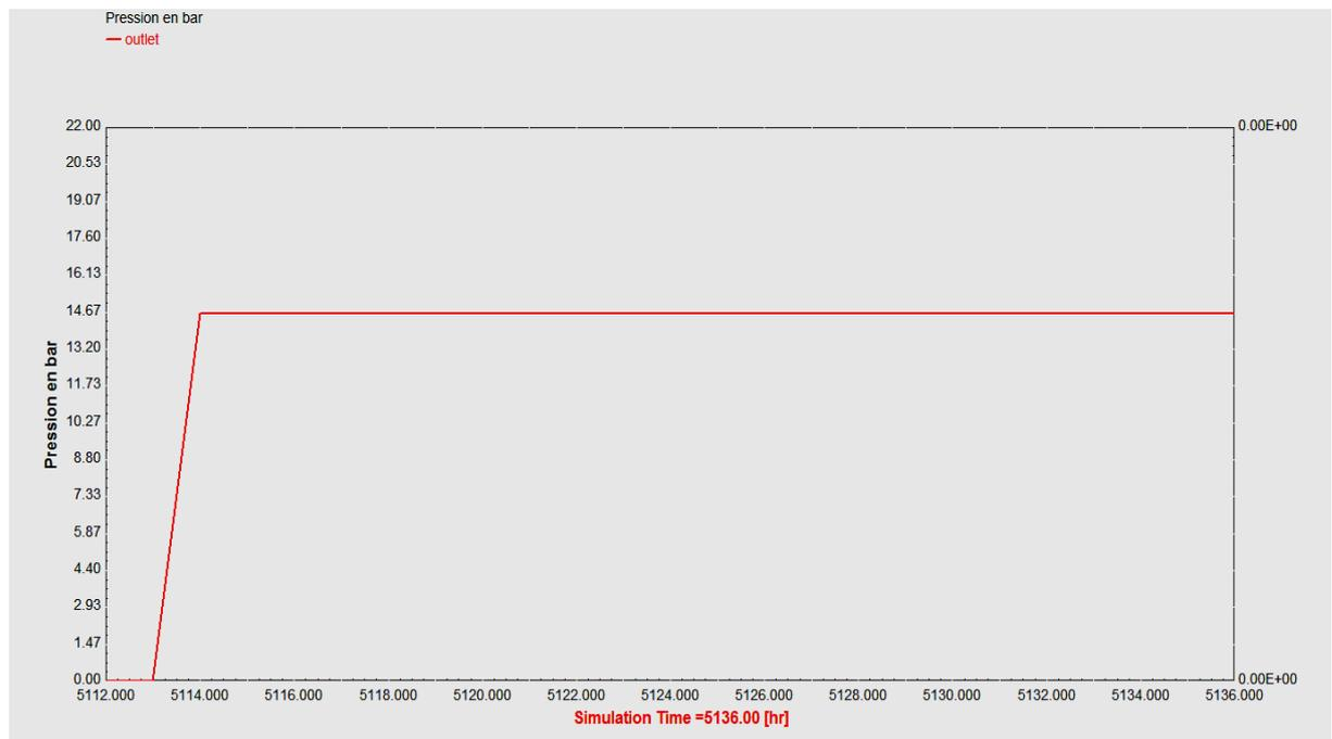
Fig 5.10La variation de pression de l'air à la chambre de combustion en bar
