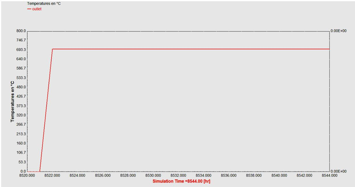
**Fig5.29**Graph de la variation de température en °C à la sortie de chambre de combustion de 21 Décembre
