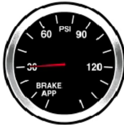
Figure 2.22 - Manomètre de pression de freinage.
