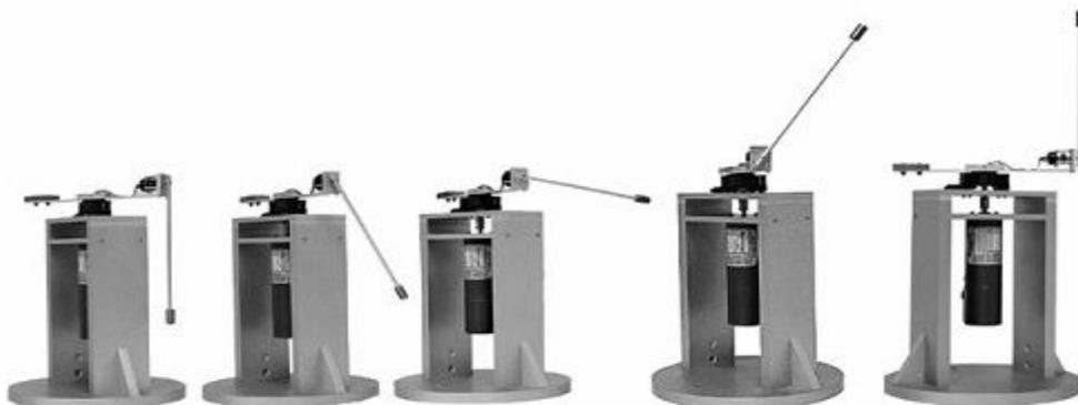
**Figure I.4 : Pendule inversé simple rotatif en action [4].**
