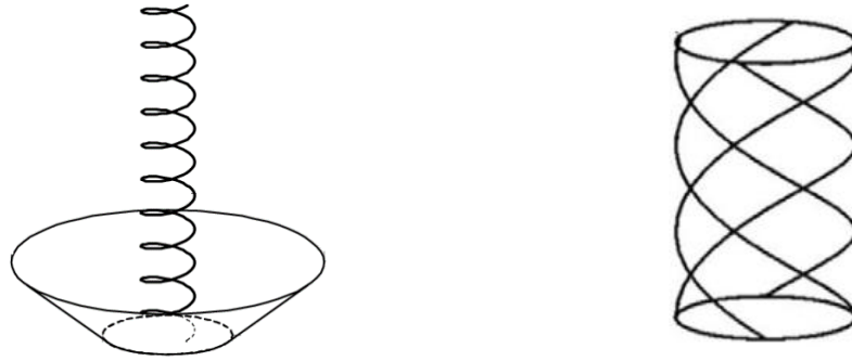
Figure 1.13 : Antennes hélicoïdales monofilaire et quadri-filaire
