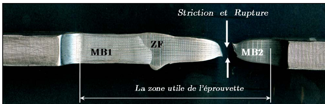
Figure V-5 : Eprouvette après rupture.
