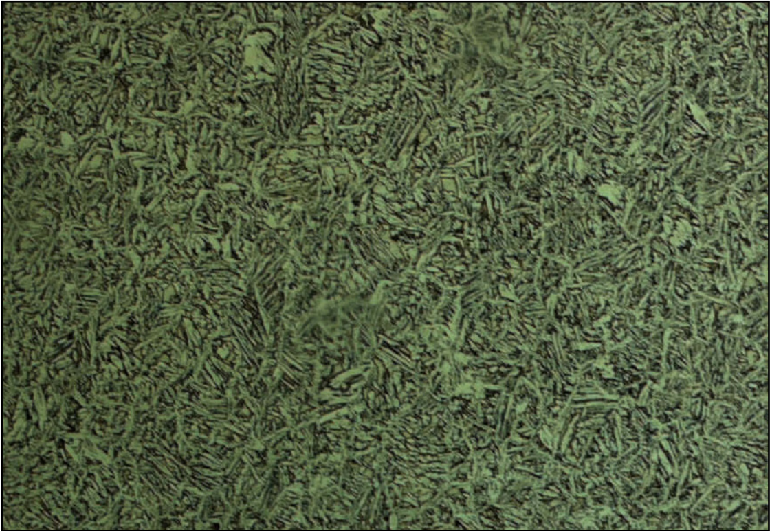
Figure IV : micrographie X50 au niveau de la zone du métal fondu.
