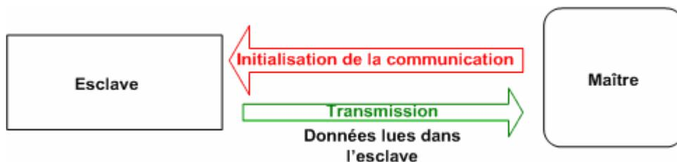
**Figure F.1** : Principe d'accès du maître vers l'esclave
