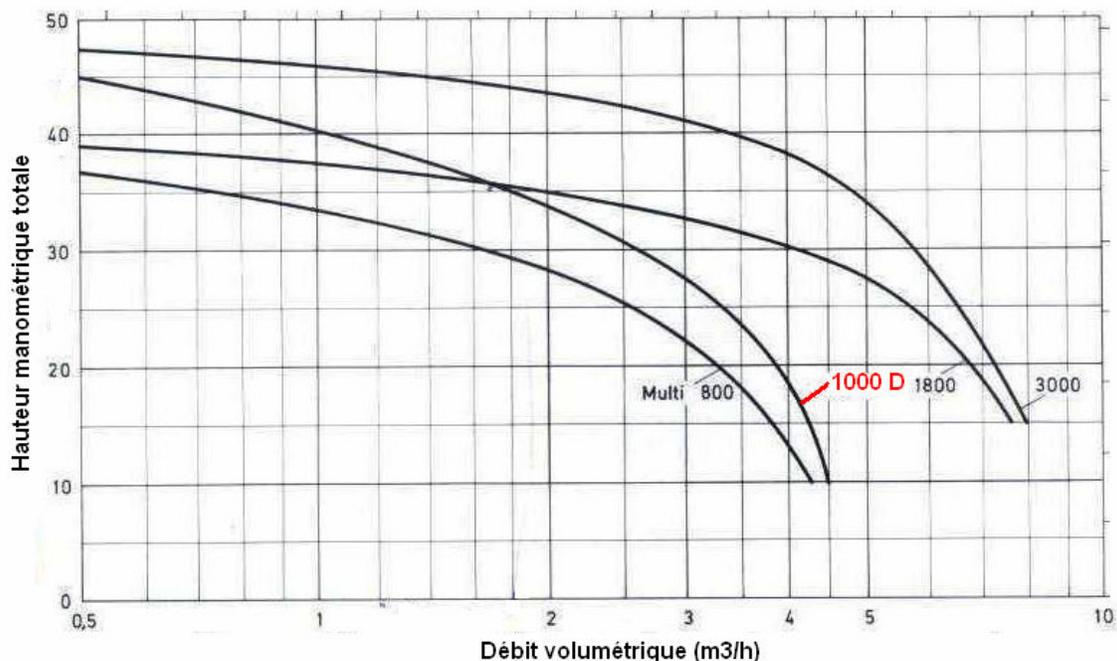
**Figure D.3** : La caractéristique Débit/HMT en régime nominale de la pompe 1000D
