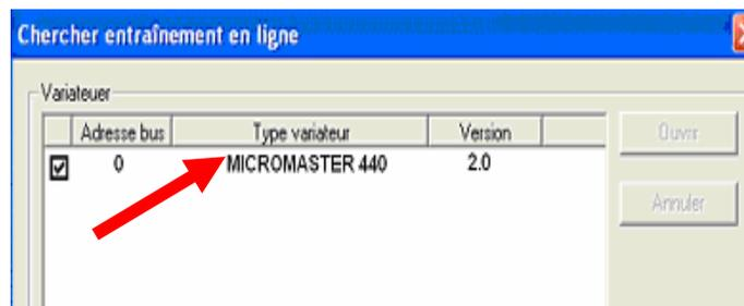
Figure II.31 : Détection et identification du variateur dans la liaison USS
