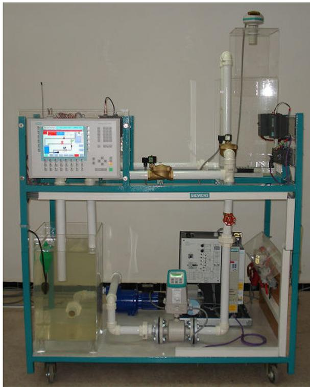
**Figure IV.1** : *Le prototype de station de pompage*
