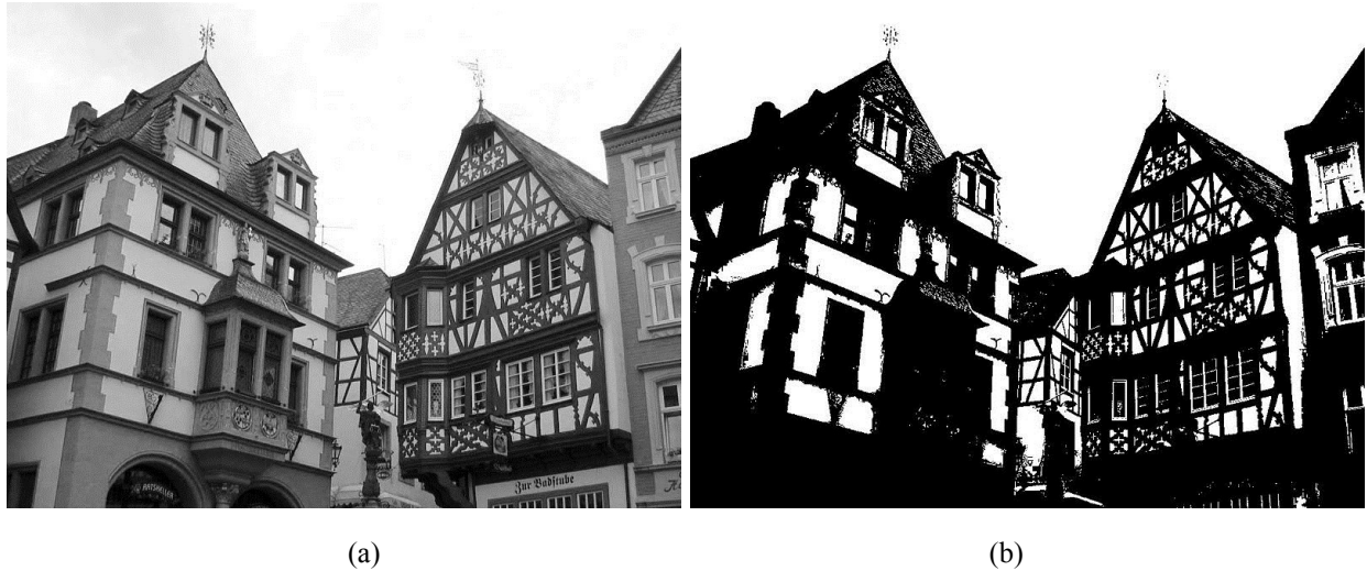
Figure II.2. Exemple de segmentation par la méthode du seuil constant, (a) Image originale et (b) Image segmentée
