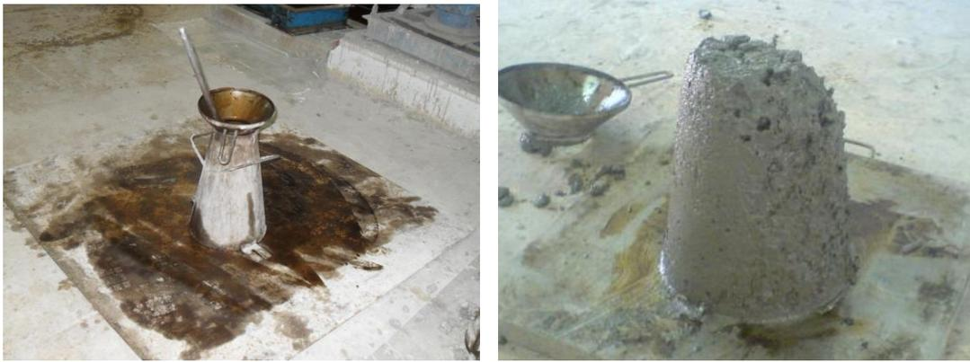
**Figure 5.1 : Mesure de l'affaissement (cône d'Abrams)**
