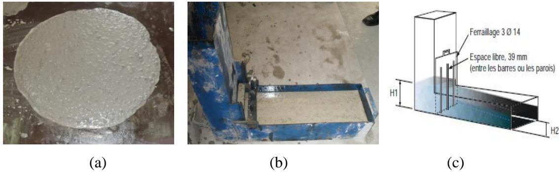
**Figure 5.21 :. Essais d'étalement (a) et de la boîte en L d'un BAP (b et c)**
