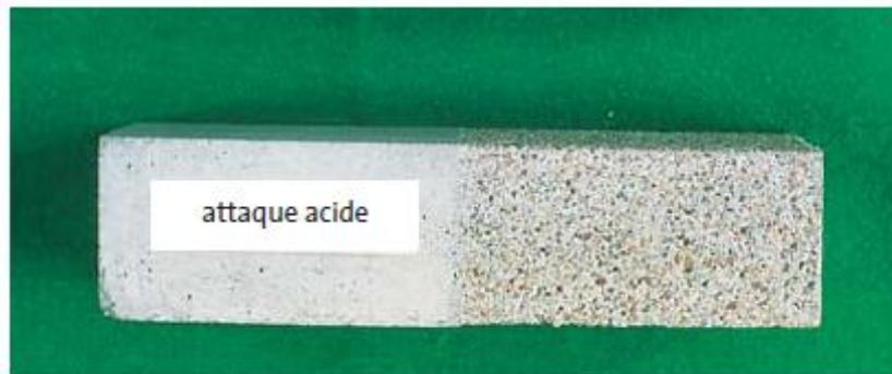
**Figure 3.6: Prisme de mortier dont la partie droit a subi l'attaque d'un acide**
