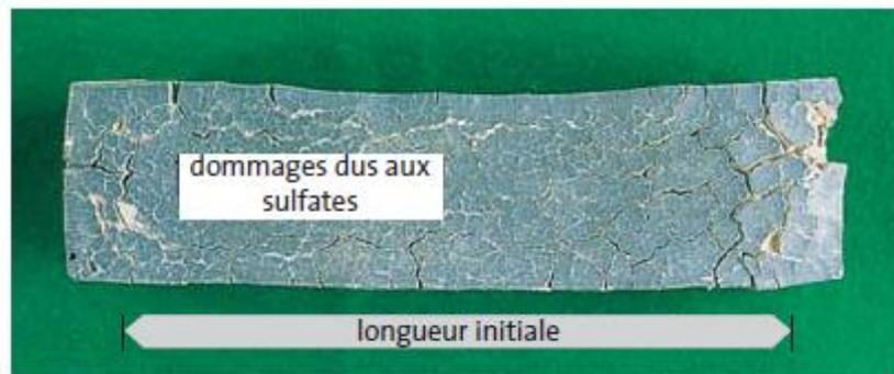
**Figure 3.8: Augmentation de volume (gonflement) d'un prisme de mortier maintenu dans une solution à haute teneur en sulfate**
