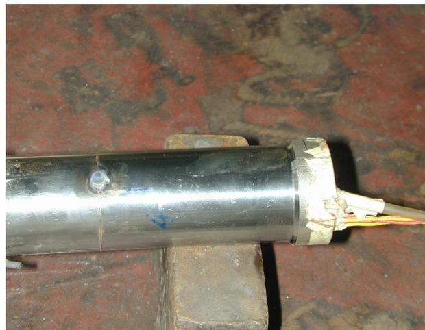
**Fig.4.5 La protection gazeuse à l'intérieur des tubes**
