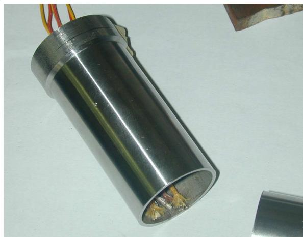
**Fig.4.3 Les thermocouples soudés sur le tube.**
