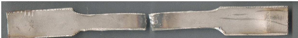
Fig. 5.15 L'éprouvette d'inox après essai de traction
