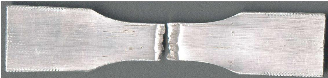
Fig. 5.13 L'éprouvette d'aluminium après essai de traction
