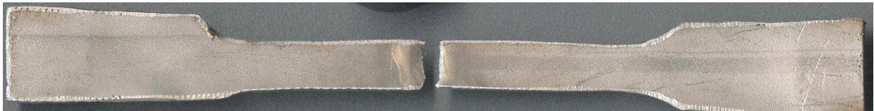
Fig. 5.17 L'éprouvette d'inox après essai de traction
