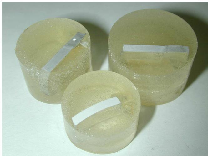
**Fig. 4.7 Les échantillons de la pièce soudée
