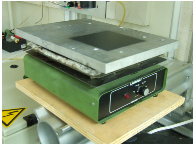
FIG. A.3: Plaque et résistance
