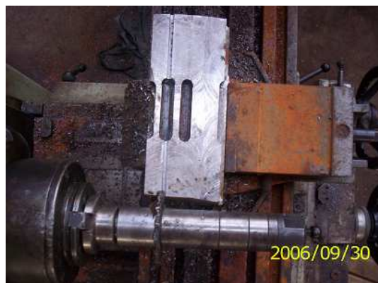
Figure III.5 : Découpage du rail.
