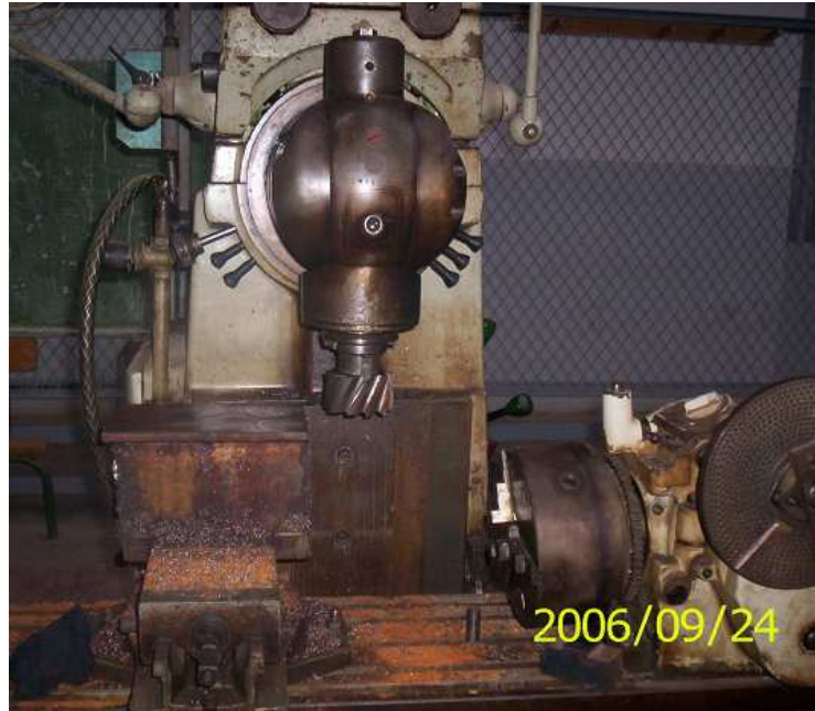
Figure III.3 : Surfaçage de la face inférieure du rail.
