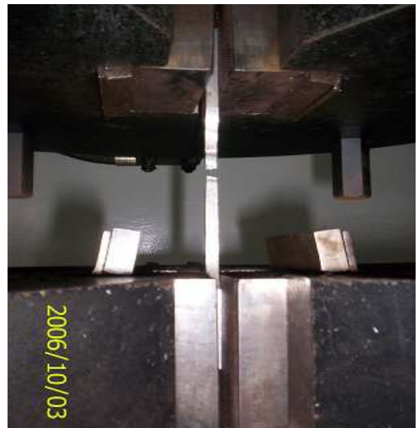
Figure III.10: Photo d'essai de traction de l'éprouvette n°3.
