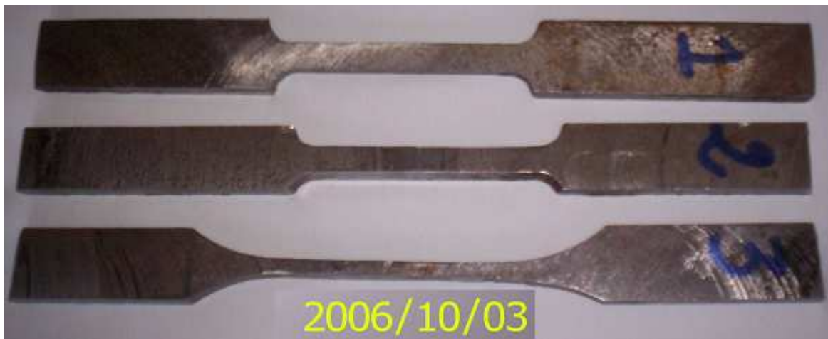
Figure III.2 : Les trois éprouvettes destinées aux essais de traction.
