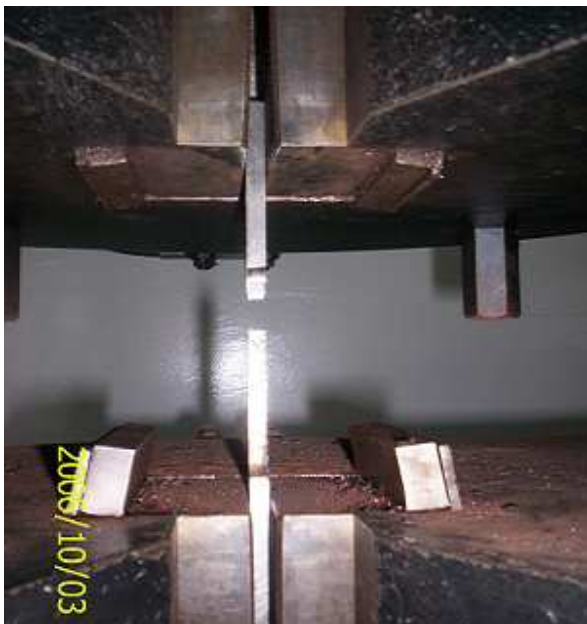
Figure III.9: Photo d'essai de traction de l'éprouvette n°2.
