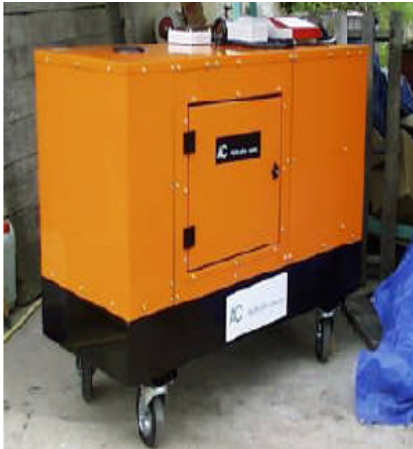
Figure II.9. Générateur 9 kva à huile de tournesol, France [20].
