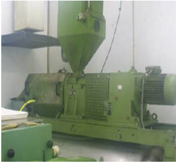
Figure II.5. Unité pour l'extraction de l'huile du tournesol 80 litres/heure, France [20].
