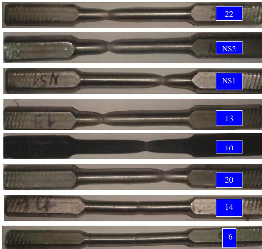
**Figure.IV.1** : photos d'éprouvettes rompues lors d'essai de traction.
