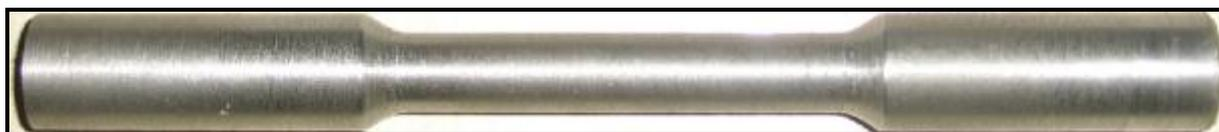
**Figure.III.6** : éprouvette usiné.
