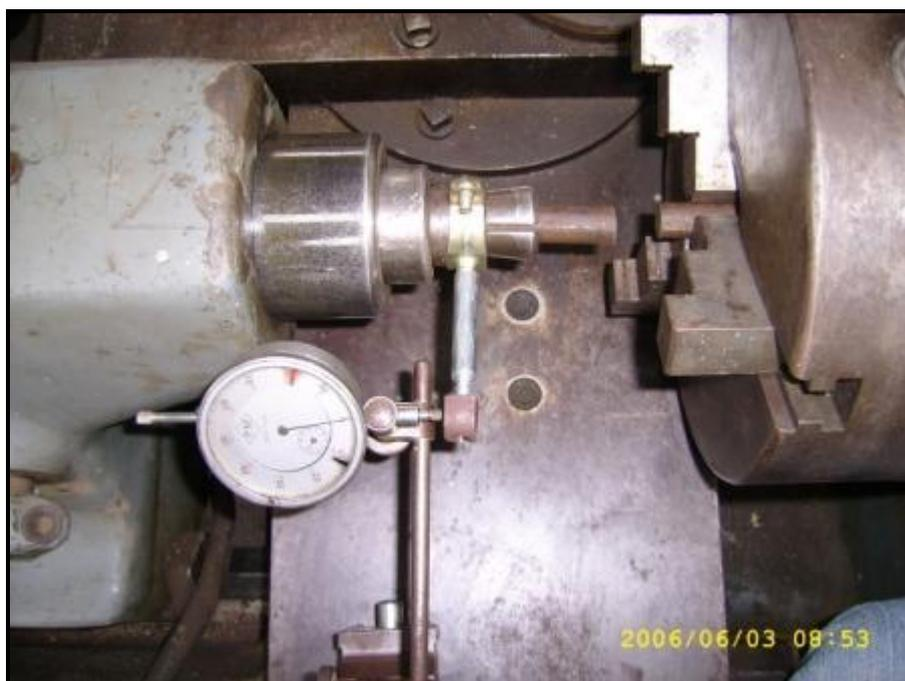
**Figure.III.3** : Emplacement du comparateur
