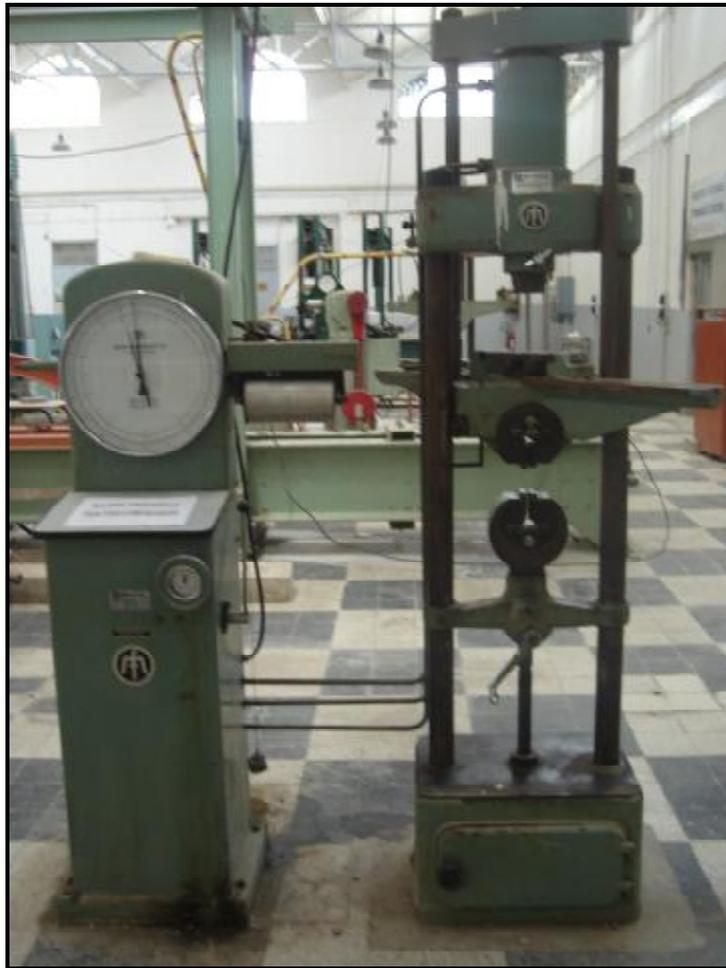
**Figure.III.8** : Image de la machine de traction
