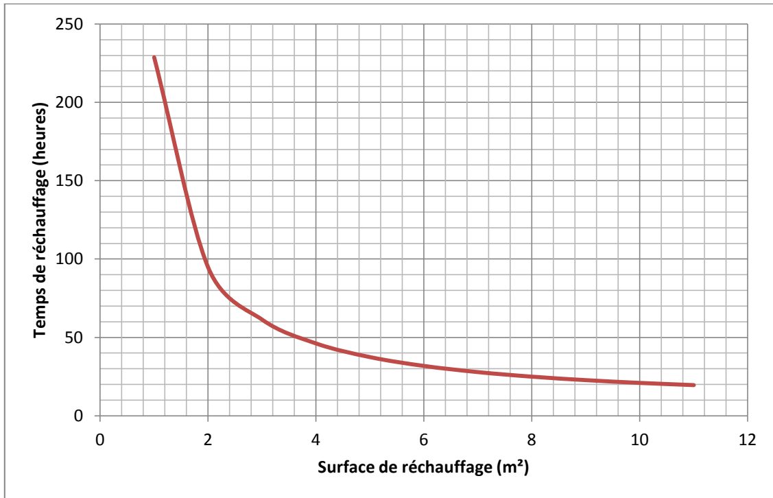
FIG A2-7 : Variation du temps de réchauffage t_5 en fonction de la surface d'échange A_{s5}
