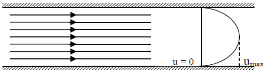
FIG 1-3 : (a) Ecoulement en régime laminaire
