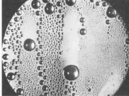
**Fig. II.9 :** Condensation en gouttes de la vapeur d'eau sur une plaque verticale. [3]
