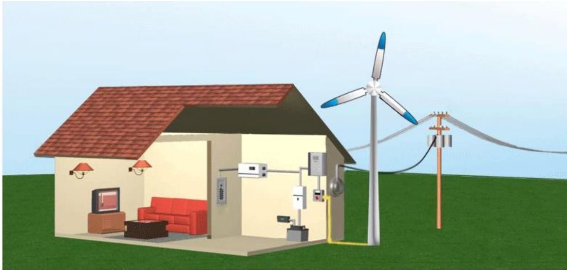
Figure 2.1 : Système éolien autonome [ZER_15]
