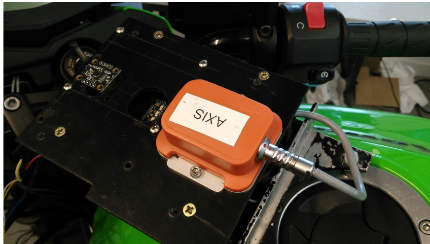
FIGURE 2.11: Centrale inertielle Xsens MTi sur la moto
