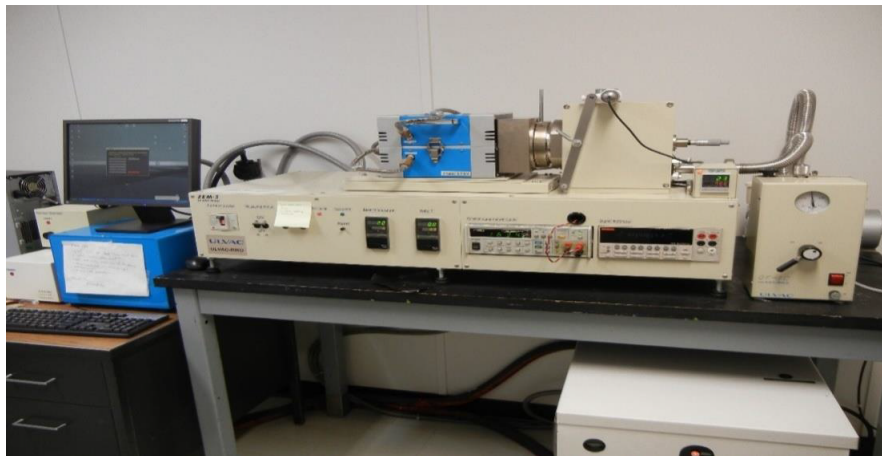
Figure 2.4: Résistivité électrique et système de mesure Seebeck (ZEM-3).
