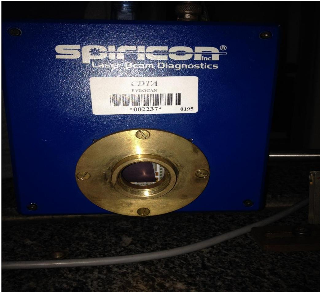
Figure 5.5 : Caméra de type Pyrocam III
