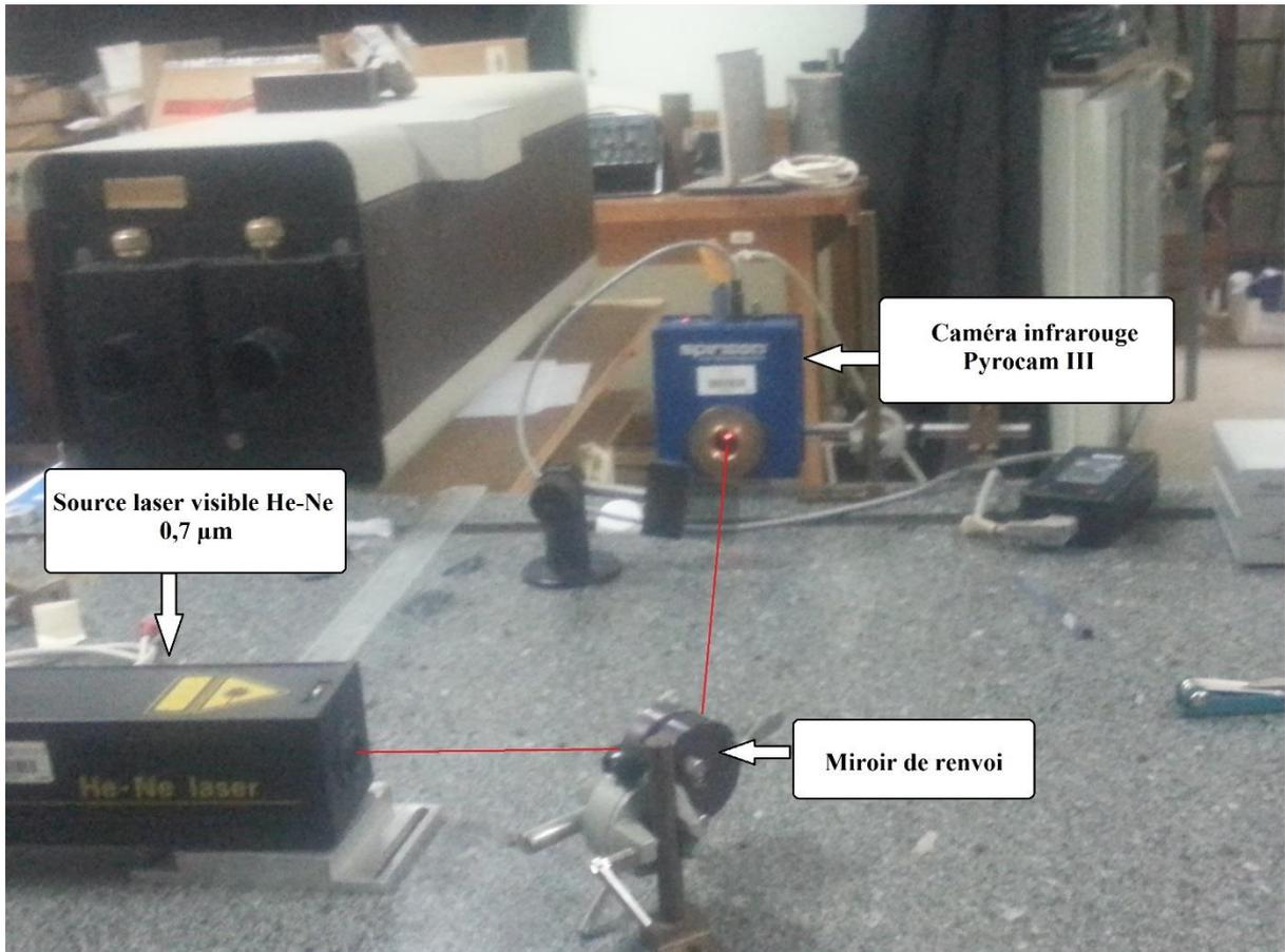
Figure 5.8 : détection du rayonnement laser He-Ne à l'aide d'une caméra infrarouge.
