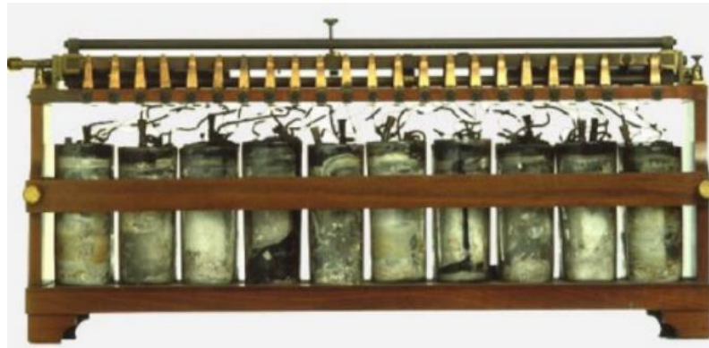
Figure 1.2: Première batterie d'accumulateurs conçue par Gaston Planté
