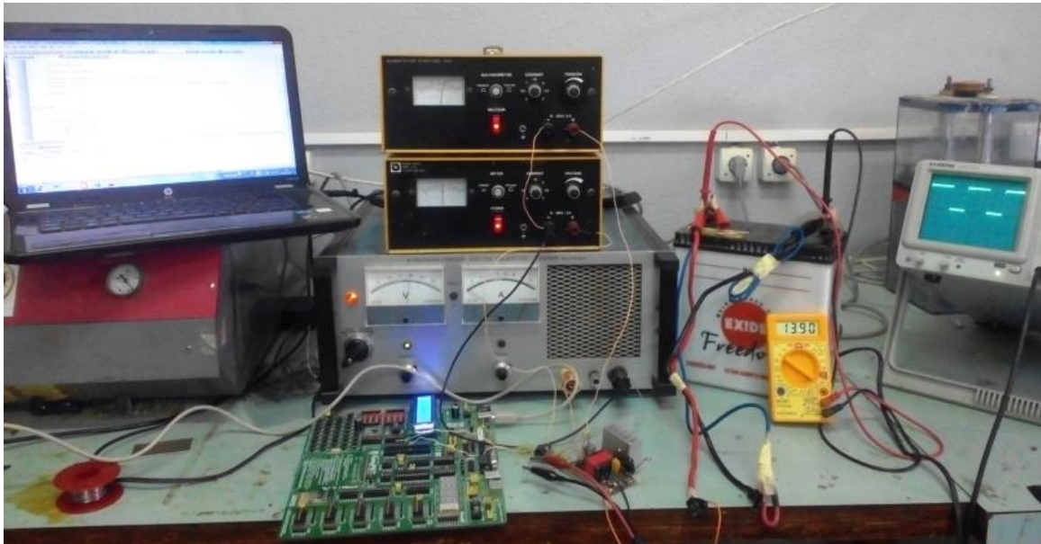
Figure 2.8 : Banc de test de la charge à tension constante
