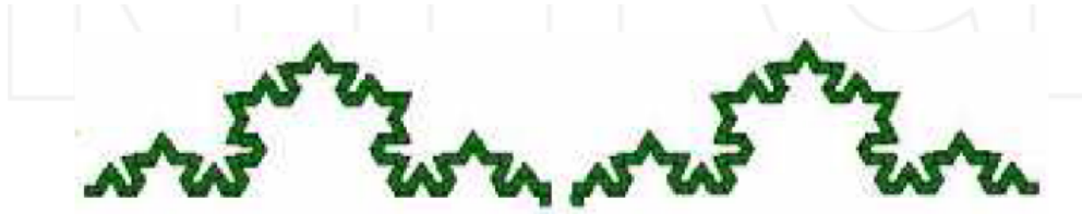
Figure 4.20 – Antenne dipôle fractale de forme de Koch d'ordre 3 [32].
