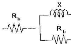
Fig. III.3 Modèle du transformateur
