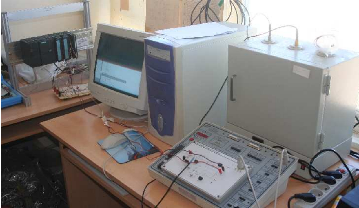
Figure III.B.8 Photo de l'ensemble Four + Capteur + Automate
