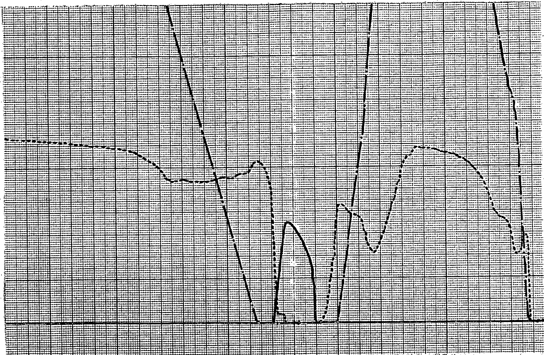
fig.III.15 - Graphes expérimentaux des pressions et du déplacement \varnothing vérin 40(mm); DC=.04(m); DB=.016(m); Course L=.1(m) essai avec M=M_m+M_0=(5+2)Kg
