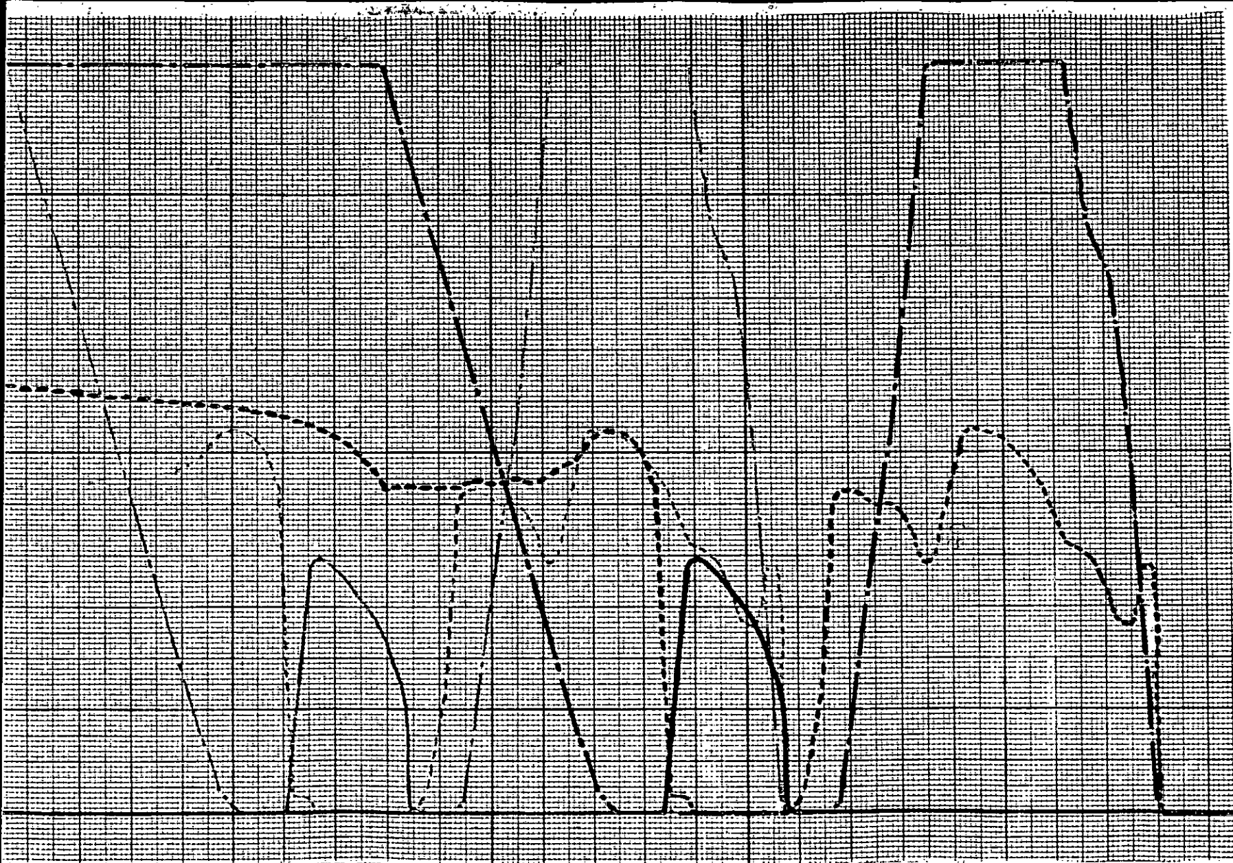
fig.III.16 - Graphes expérimentaux des pressions et du déplacement Ø vérin 40 (mm); DC=.04 (m); DB=.016 (m); Course L=.1 (m) essai avec M=M_m+M_0=10+2 (Kg)
