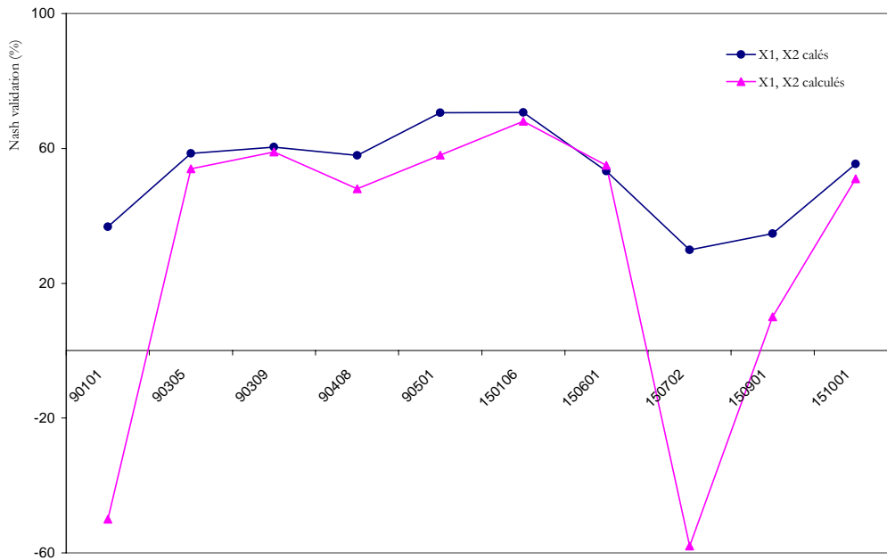
Figure 6.6 : Comparaison des valeurs de Nash pour les paramètres calés et calculés
