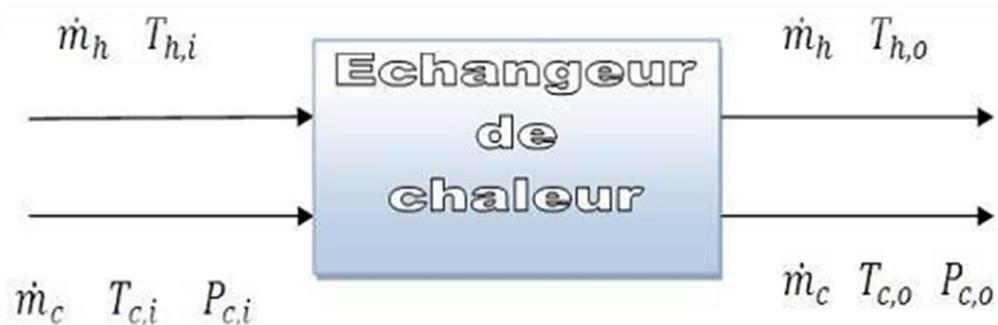
Fig. III.2 : bilan énergétique autour d'un échangeur de chaleur co-courants.
