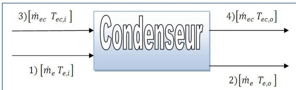
**Fig. V.4** : Bilan énergétique du condenseur
