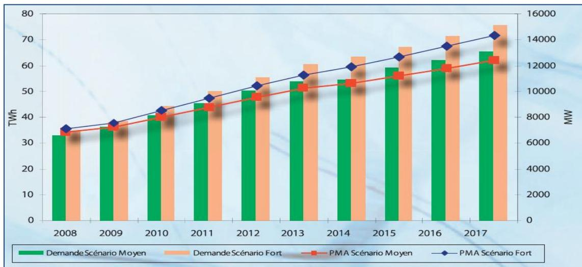
Fig. II.4 : Evolution des PMA et des consommations d'énergie électrique 2008-2017 [6]
