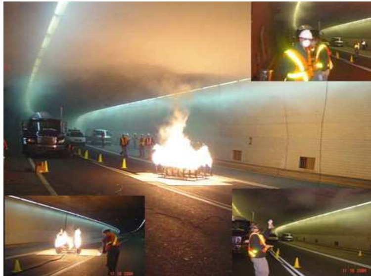
Fig. 2.11 Les essais d'incendie faits au tunnel de L. H. la fontaine (Canada).
