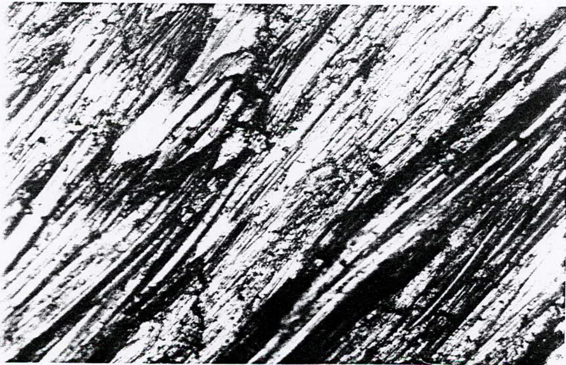
*Fig. IV.11 traces d'usure et formation des débris pour un échantillon traité 1<sup>h</sup> (X100).
