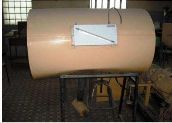
**Fig3.3: Réservoir a air**
