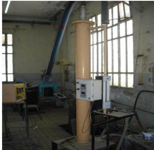
**Fig3.5: calorimètre des gaz d'échappement**
