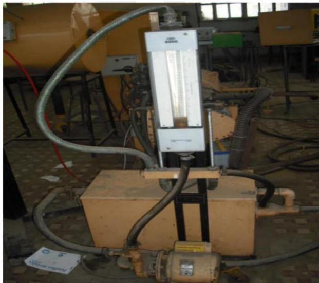
**Fig3.4 : bac et pompe de refroidissement**
