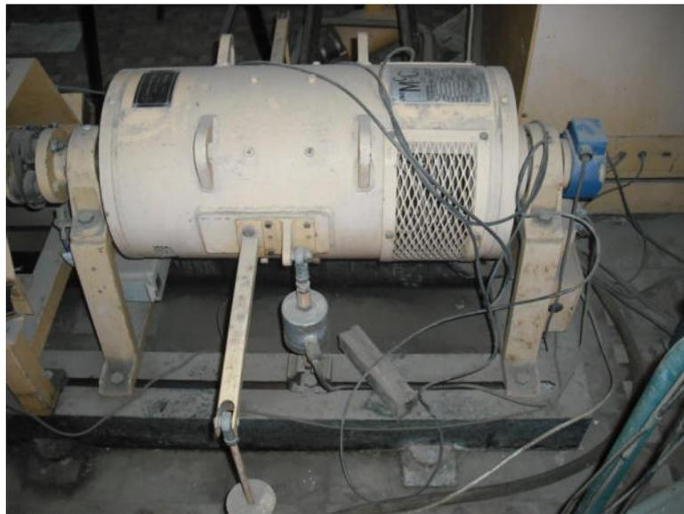
**Fig3.1 : dynamomètre**
