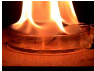
Fig. 4.18 : photographie de la flamme à t= 400 s pour le bac en Pyrex ® .
