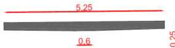
Figure III.12) - Caractéristique géométrique de la section de béton
