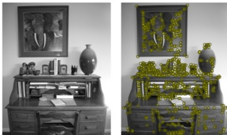
FIGURE 1.4: Exemple de détection de coin à l'aide de Harris
