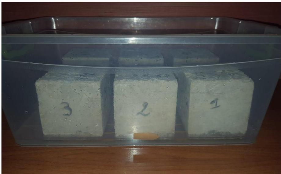
Figure 5.4.6 : Essai d'absorption d'eau par capillarité.
