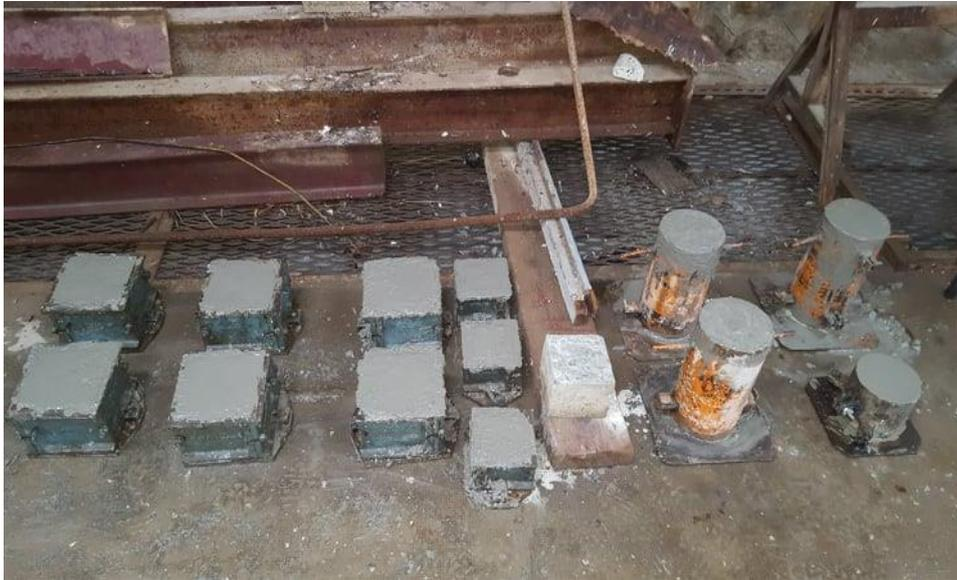
Figure 5.3.3 : Coulage des éprouvettes cubiques et cylindriques.
