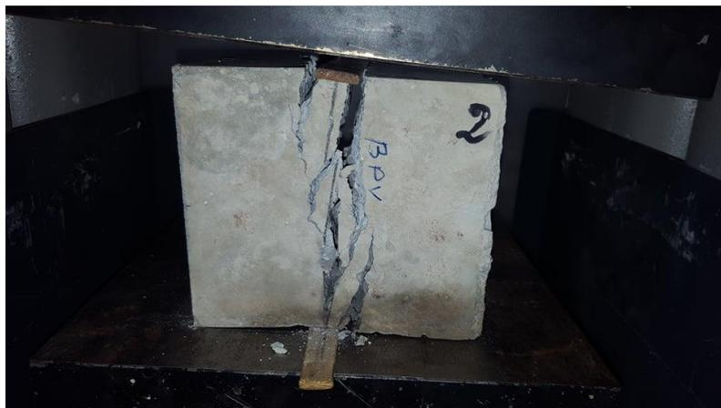
Figure 5.4.8 : Fendage de l'éprouvette.
