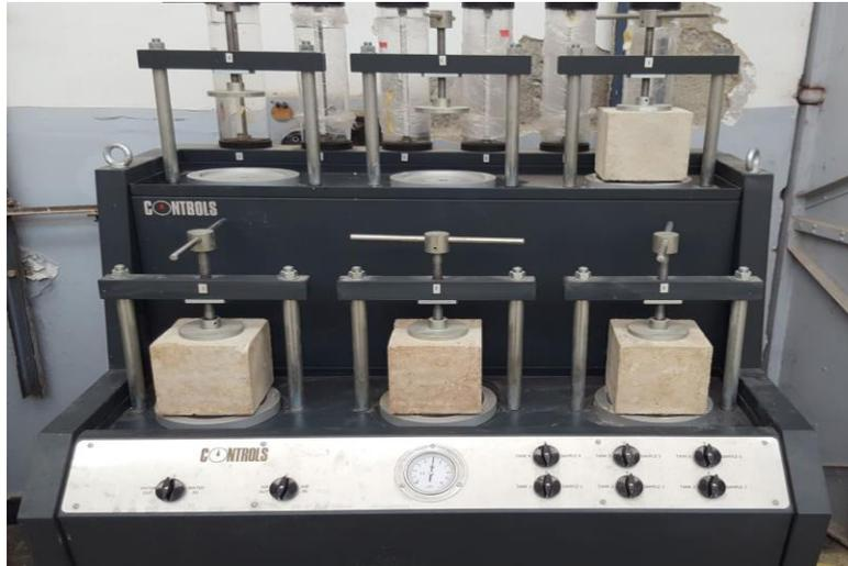
Figure 5.4.7 : Essai de perméabilité à l'eau.
