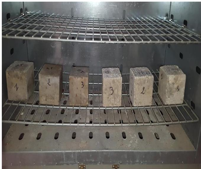
Figure 5.4.5 : La dessiccation des éprouvettes après immersion.
