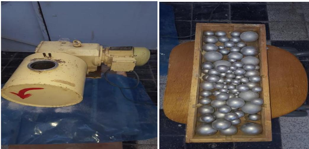
Figure 5.2.1 : Broyeur à boulet.
