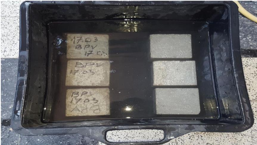
Figure 5.4.4 : Immersion des éprouvettes dans le bac à eau.
