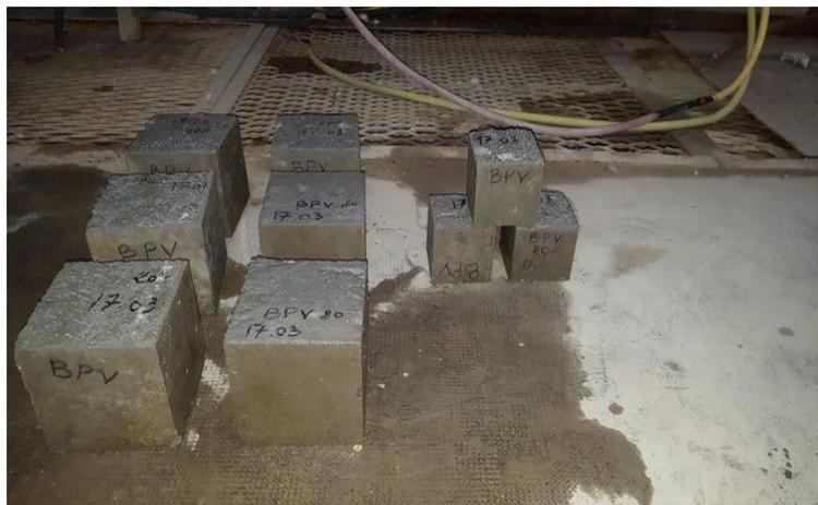
Figure 5.3.4 : Identification des éprouvettes.
