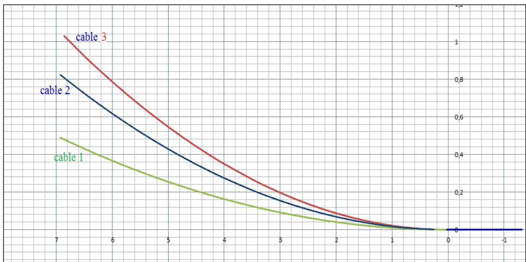
Figure VI.9: Allure des trois câbles
