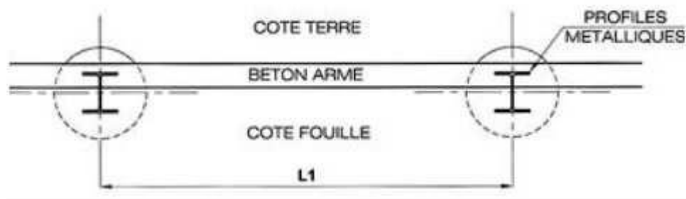
Figure annexe 2 1. 4 Plan représentatif de la paroi berlinoise
