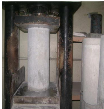
Figure II.8 : Essais d'écrasement en compression simple.
