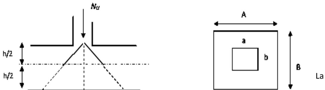
Figure 6.4. présentation de la zone d'impact de la charge concentrée.
