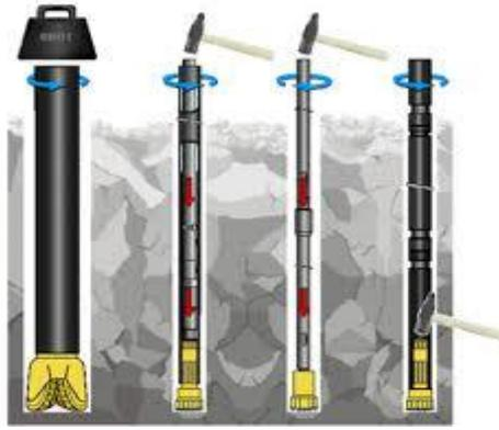
Figure 3.3 : Réalisation d'un sondage destructif.
