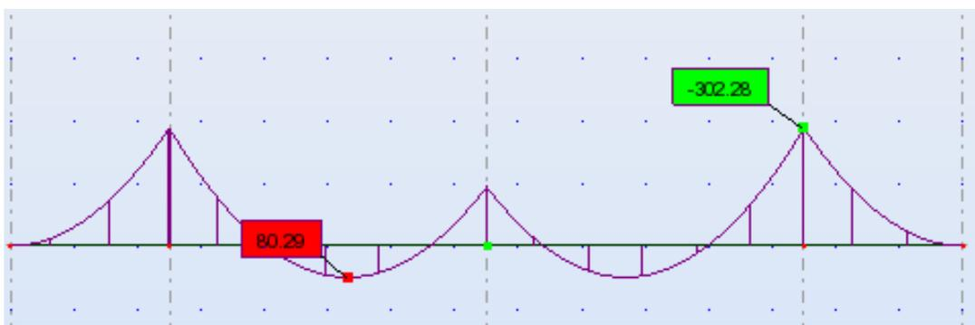
Figure 11-12: diagramme du moment fléchissant (t.m) à l'ELS
