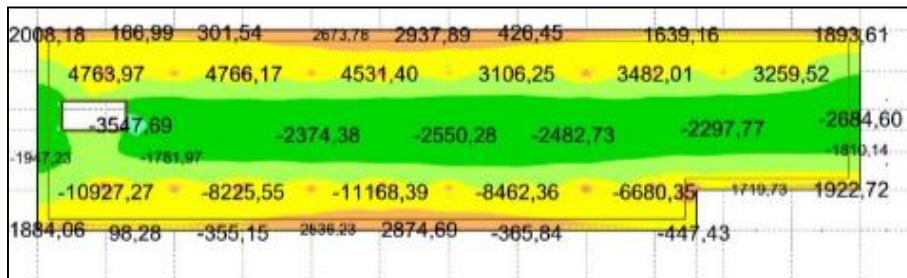
Figure III-12: Moment fléchissant (dalle de couverture)
