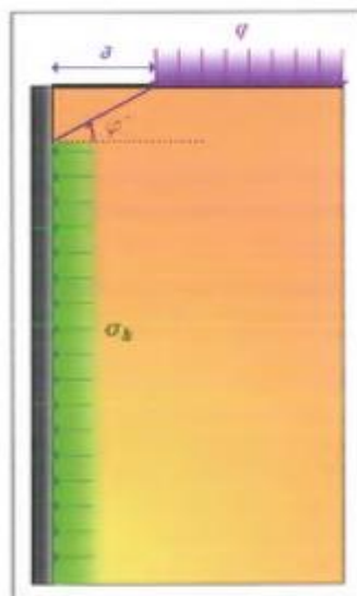
Figure B-1 : prise en compte de l'effet de la surcharge sur les contraintes (Eurocode 7)
