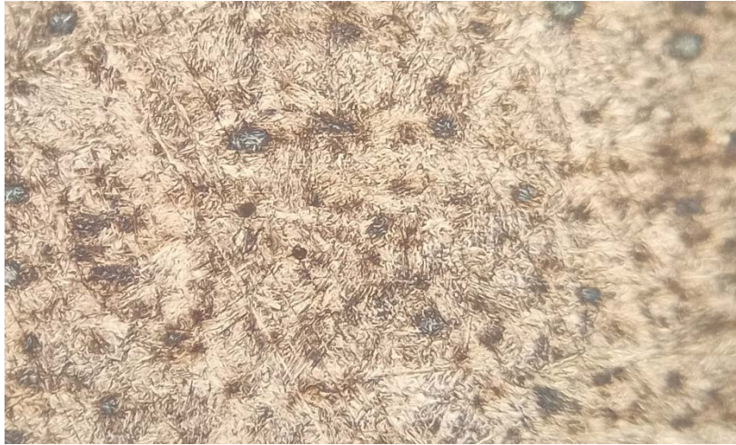
Figure 50 Photo micrographique, structure de la martensite correspondante à la faible dureté obtenue dans le cas de la trempe à huile position 2. \times 400 , Nital 2%
