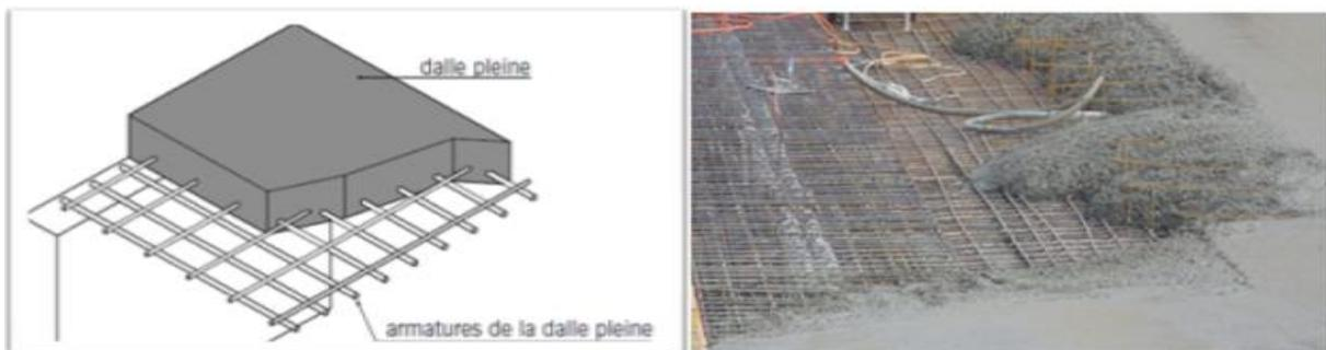
Figure II.1 : Plancher en béton armé.
