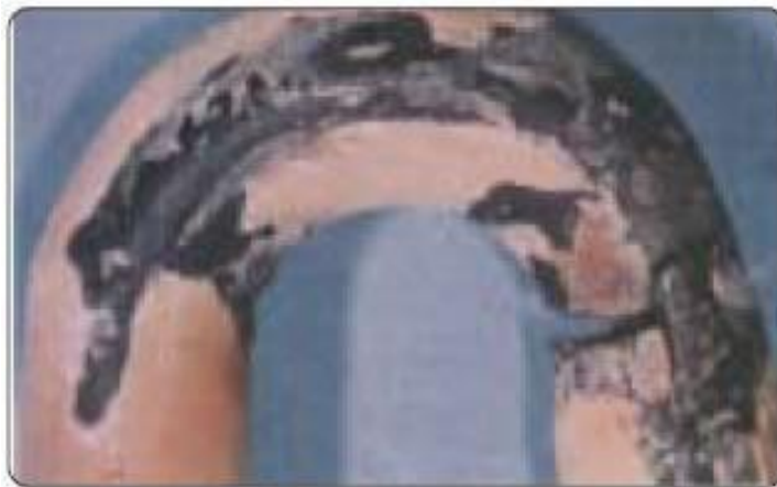
Figure 3-8 : Rupture par fatigue thermique dans un secteur en U.
