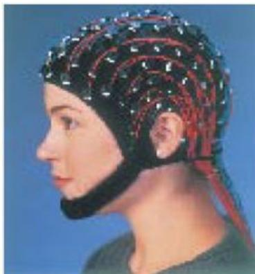
FIGURE 1.6: Dispositif pour l'acquisition du signal EEG avec 128 électrodes.[2]
