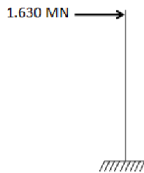
Figure X.9. Force de freinage appliquée sur la pile
