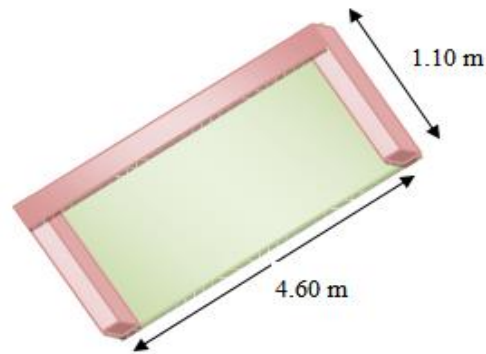
Figure 4.6. Dalle pleine sur 3 appuis continus
