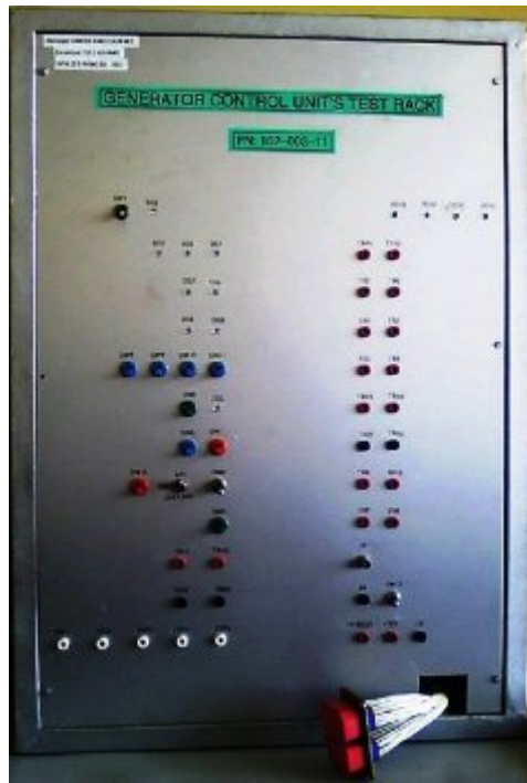
FIGURE 3.1: Le banc de test du GCU P/N 102-003-11
