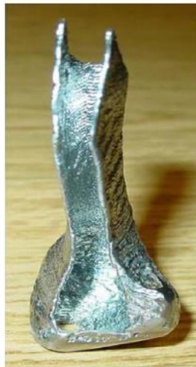
Figure 0.4 Echafaudage Ti-6Al-4V qui a été produit par le procédé DMD.
