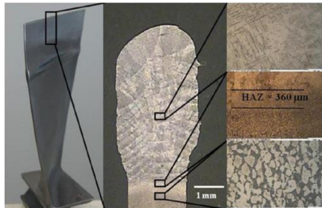
Figure 0.3 Réparation par DMD des composants de turbine; à gauche: aube réparée, au milieu: macro en coupe et à droite: microstructures (de haut en bas montre le revêtement, l'interface et le matériau de base).
