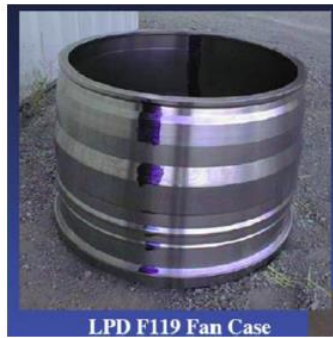
Figure 0.4 Boîtier de ventilateur produit en ajoutant des fonctionnalités avec FA (dépôt d'énergie dirigé assisté par laser) à une pièce forgée.
