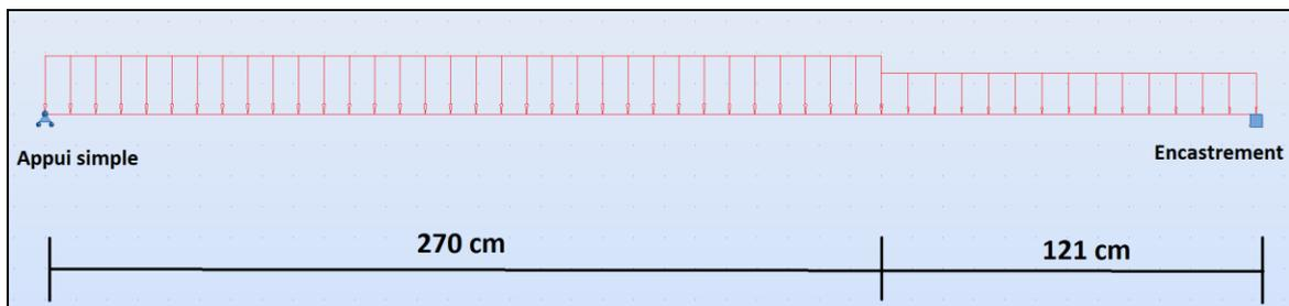
Figure 0-9 : Schéma statique de l'escalier (Autodesk Robot Analysis Structural).
