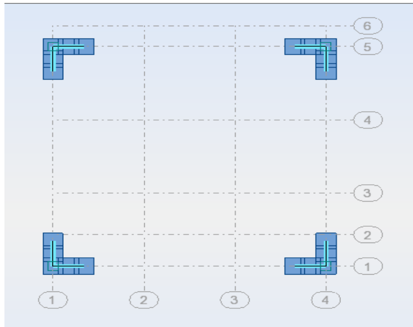
Figure V.3 Emplacement des voiles.
